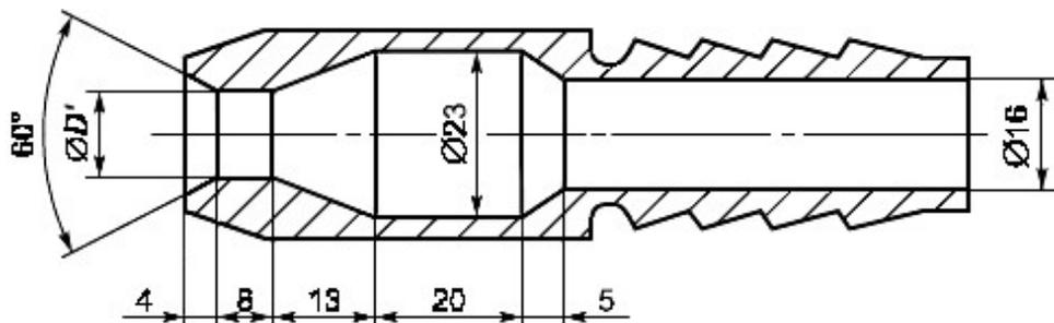
$D' = 6,3$  мм для испытания по 9.2.6 (вторая цифра в обозначении степени защиты 5).
