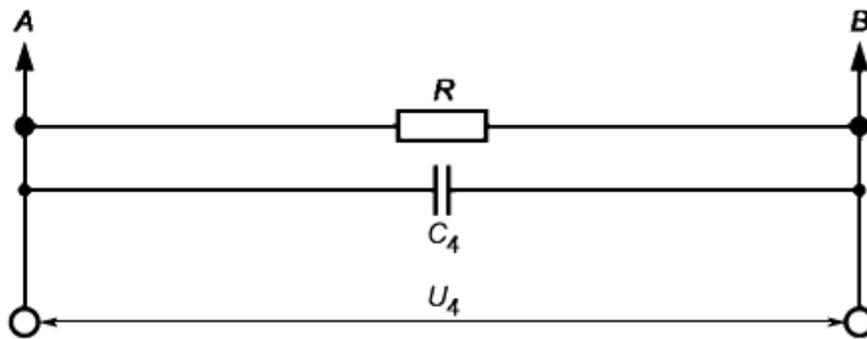
$$I_{\text{защитный}} = U_4 / R; R = 150 \text{ Ом}; C_4 = 1,5 \text{ мкФ}$$
