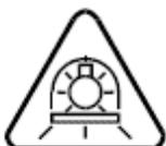
Примечание 2 - Лампы с экранированием излучения, предназначенные для работы в светильниках без защитного экрана, являющегося частью светильника, должны иметь маркировку упаковки ламп следующим символом:
