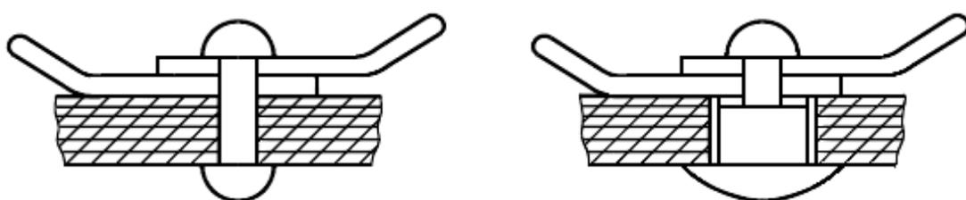
[Рисунок 18 - Примеры безвинтовых контактных зажимов пружинного типа](#)
