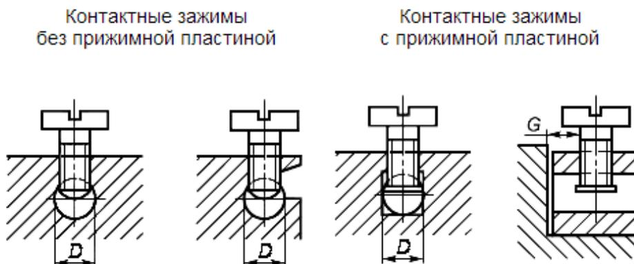
[D - диаметр гнезда жилы провода, G - расстояние между винтом и концом полностью введенной в зажим жилы](#)
