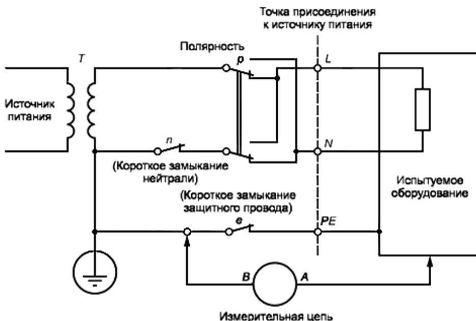
Рисунок G.1 - Схема испытания:
