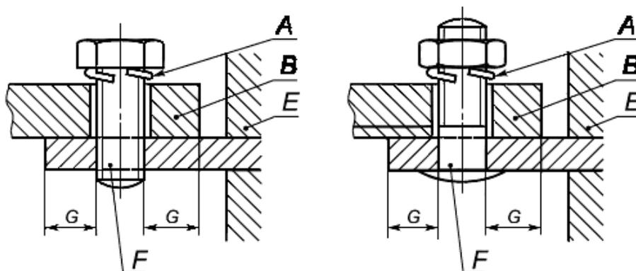
$A$  - устройство защиты от самоотвинчивания;  $B$  - кабельный наконечник или плоский вывод;  $E$  - опорная деталь;  $F$  - шпилька;  $G$  - расстояние между краем отверстия и боковой стороной кабельного наконечника или плоского вывода
