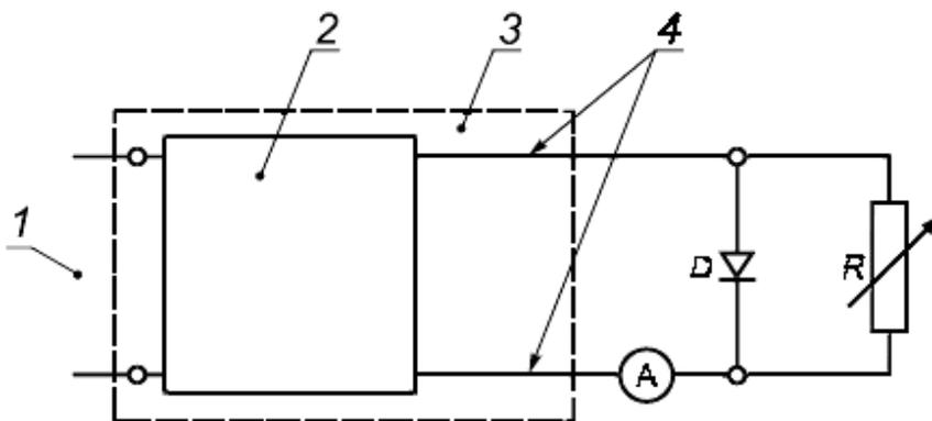
1 - сеть; 2 - ПРА, трансформатор, зажигающее устройство; 3 - светильник; 4 - место присоединения лампы;  $D = 100 \text{ A}, 600 \text{ В}$ ;  $R = 0 \dots 200 \text{ Ом}$  (номинальная мощность резистора должна быть не менее  $\frac{1}{2}$  мощности лампы)
