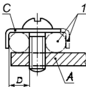
[Контактные зажимы с крепежным винтом](#)
