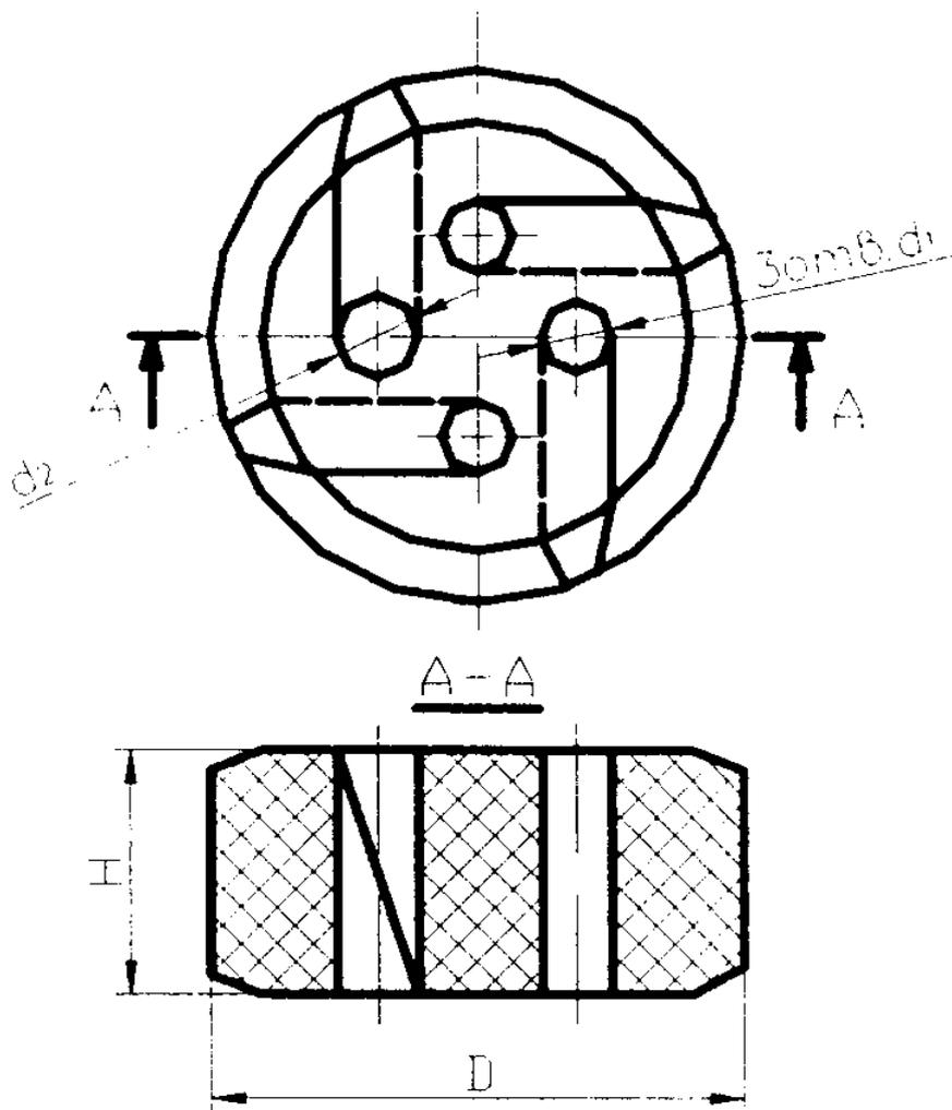
Рис. П6.1. Кольцо для уплотнения проводов
